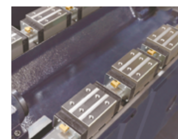
Роликовые линейные направляющие с 3 каретками на осях X/Z
