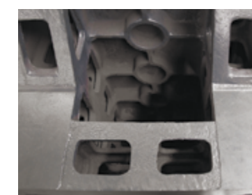
Двухслойная конструкция коробчатого типа колонны и станины
